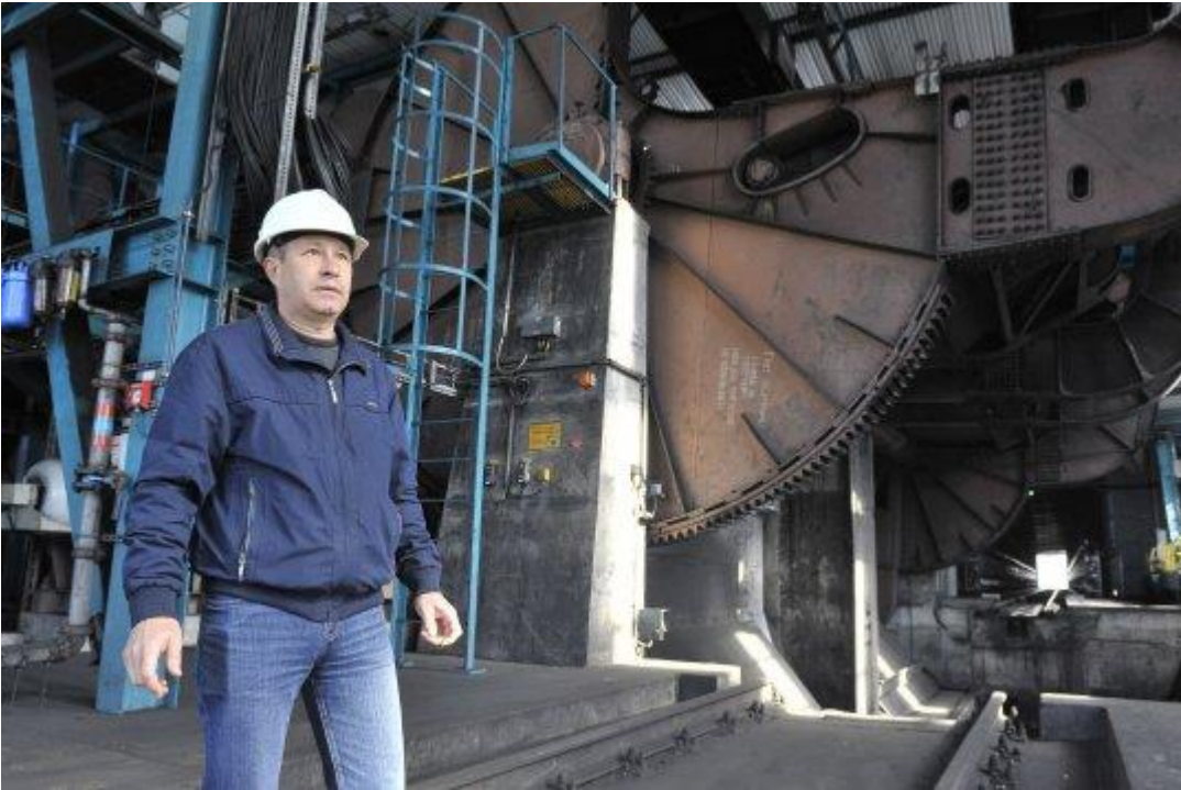
Работу вагоноопрокидывателя, который автоматически выгружает вагоны, демонстрирует заведующий эксплуатационным отделом Сергей Река.
